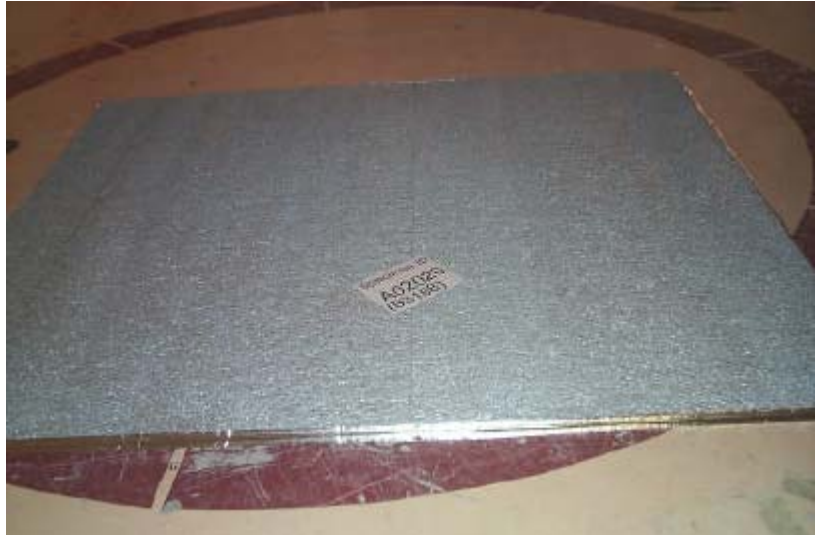
Bild 2: Die Verbindung zwischen den Teilen wurde nicht überklebt.
