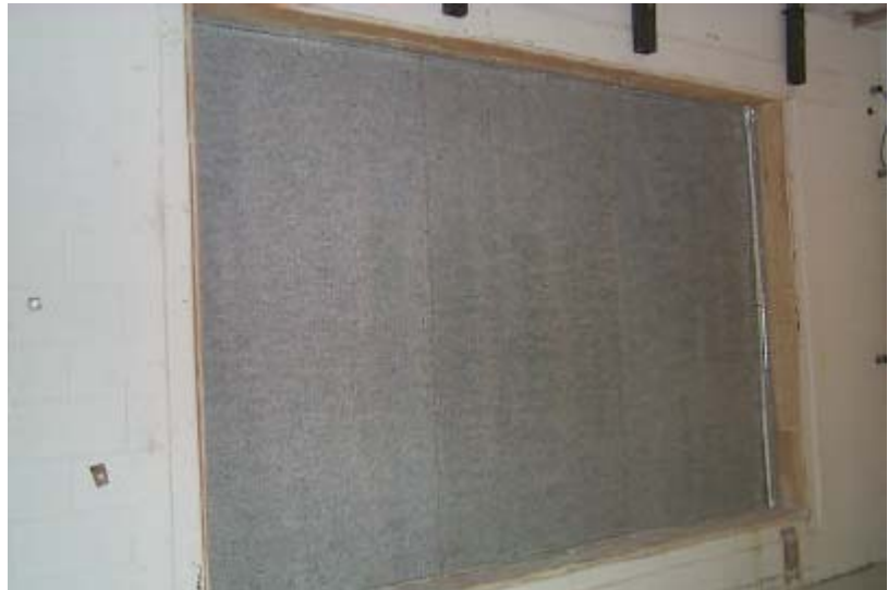
Bild 7: Das Muster wurde an der Füllwand auf der Seite des kleinen Raumes montiert.
